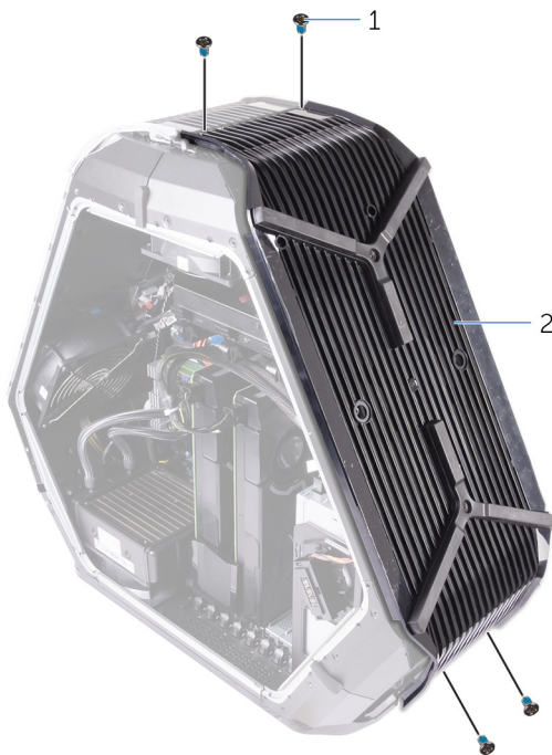
Afbeelding 72. De onderplaat verwijderen
