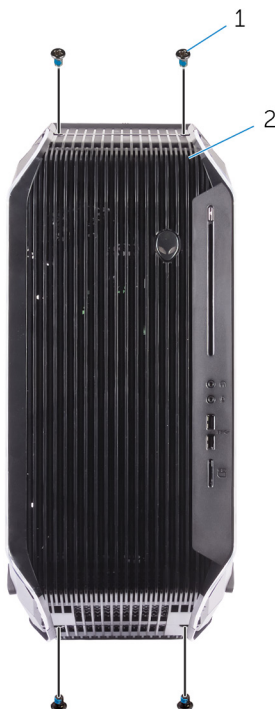
Afbeelding 60. Verwijderen van de schroeven
