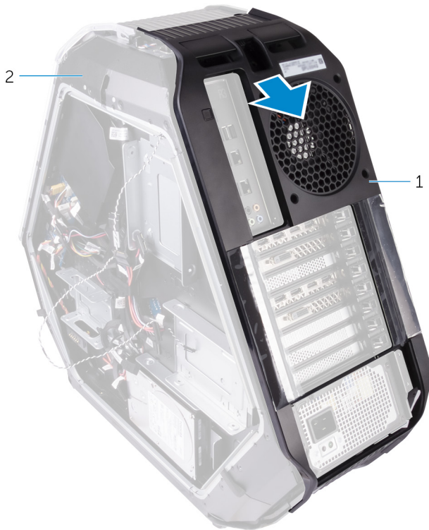
Afbeelding 71. Het achterste montagekader verwijderen
