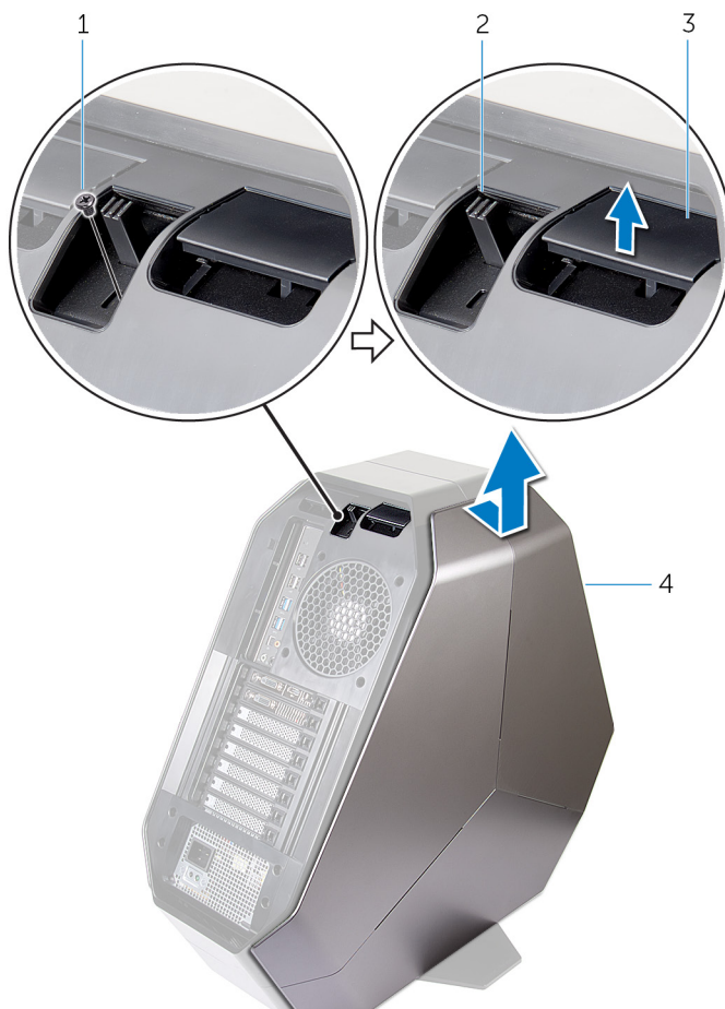
Afbeelding 8. Het zijpaneel verwijderen
