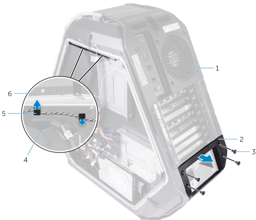
Afbeelding 68. De achterste verlichtingskabel voor I/O-toegankelijkheid verwijderen
