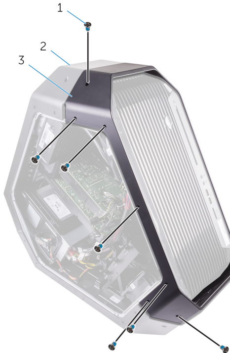
Afbeelding 56. Verwijderen van de schroeven
