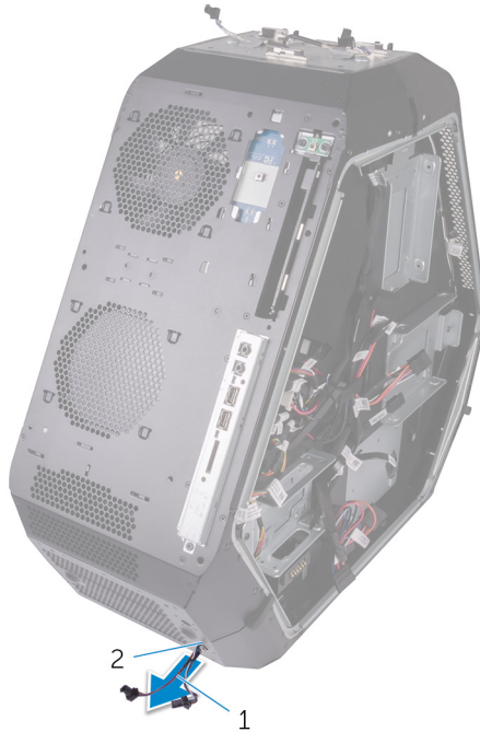
Afbeelding 79. De onderste tron-verlichtingskabels verwijderen
