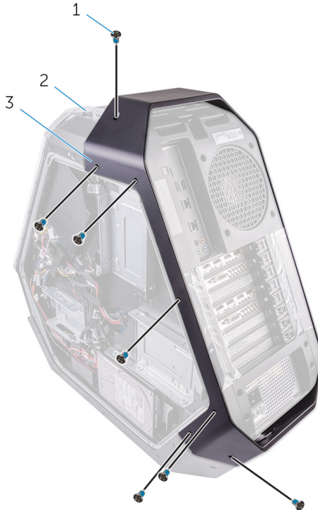
Afbeelding 54. Verwijderen van de schroeven
