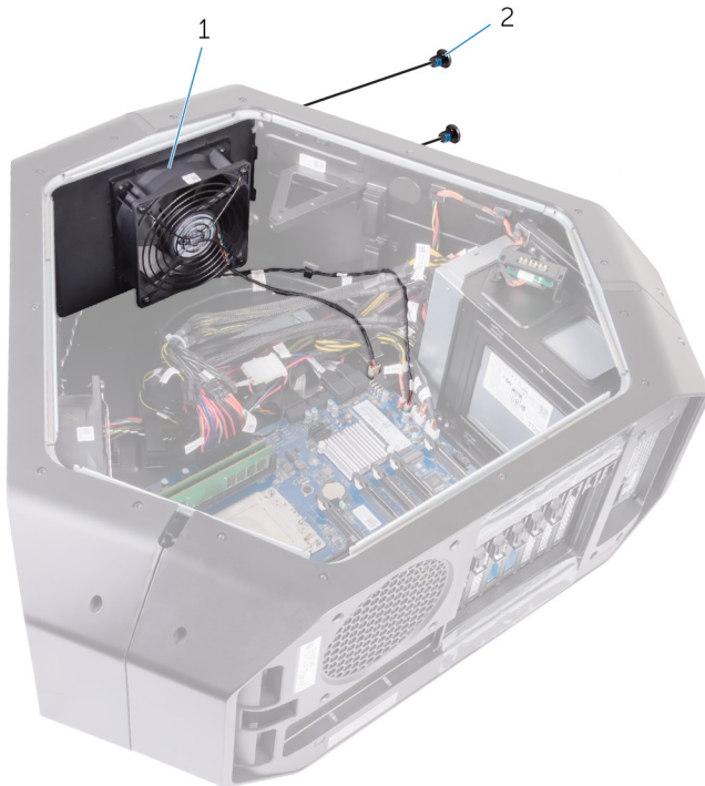
Afbeelding 41. De PCI-ventilator verwijderen
